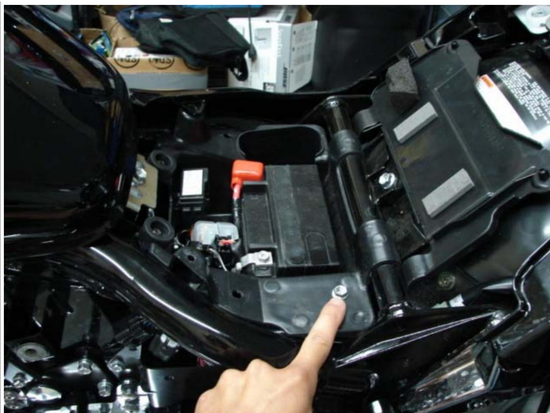
Après avoir desserré ces boulons, l'ordinateur et sa cage de montage seront libres.
